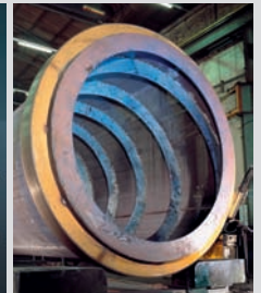
Drum including race and conveying screw / Trommel mit Laufringen und Förderschnecken
