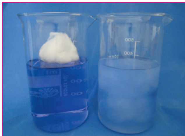
Abb. 6: Hydrophobe Viskosefaser Olea auf Wasser (links) im Vergleich zu Normalviskose (rechts, Fasern in Wasser eingesunken)
