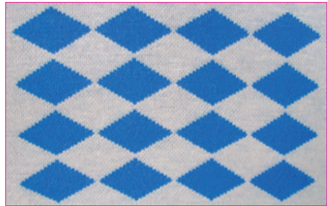
Abb. 4: Farbstoffaufnahme kationischer Danufil® Deep Dye Viskosefasern (blaue Stellen) im Vergleich zu Normalviskose (weiße Stellen)
